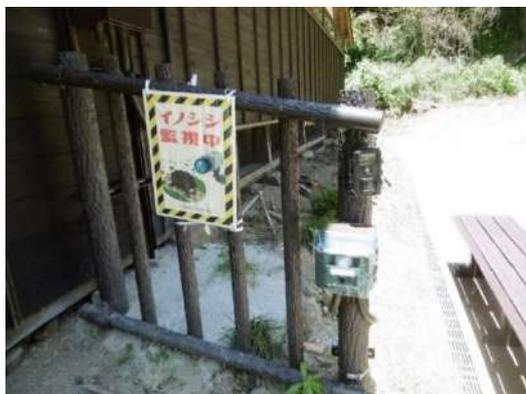
センサーで感知して威嚇音・高周波・フラッシュ点滅（青色LED）を発生させる装置。イノシシ防護柵の開口部（出入口）に設置されている。効果やイノシシの進入状況を確認するため、センサー付きカメラも設置（名勝常德寺庭園…山口市）
